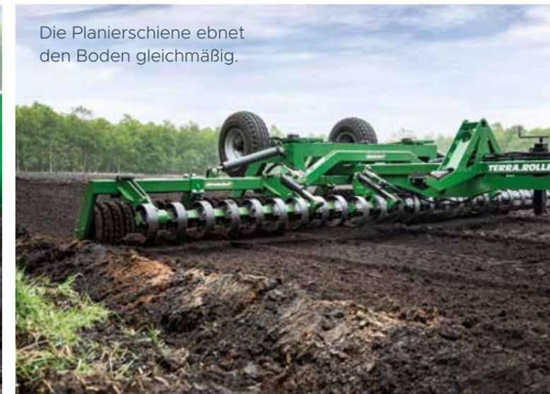
Die Planierschiene ebnet den Boden gleichmäßig.
