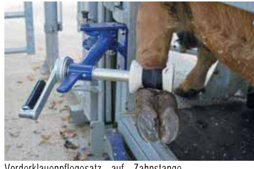
Anti-Rückkehr Vorrichtung mit Zahnrad.
