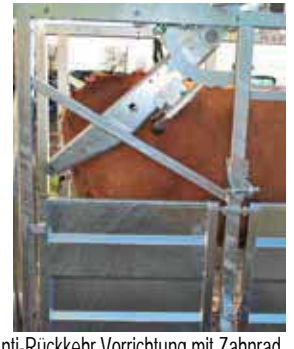
Anti-Rückkehr Vorrichtung mit Zahnrad.
