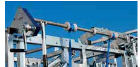
Anti-Rückkehr Vorrichtung mit Zahnrad.
